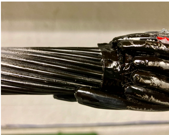
(c) Ponta esquerda da emenda marcada por tinta depois - Ensaio 3.
