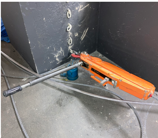
(a) Talha de alavanca para pré-carga.
