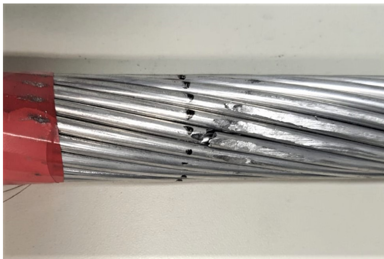
Figura 4.9 – Condutor com quebras após desmontagem do grampo - Ensaio 4.
