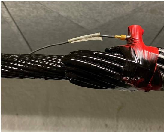
(a) Ponta da emenda marcada por tinta antes do Ensaio 5.
