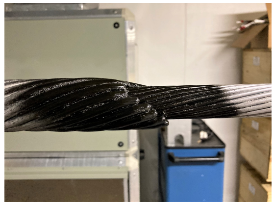
(b) Ponta direita da emenda após ensaio de varredura de frequência.
