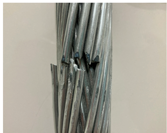
(b) Quebras dos fios após a desmontagem do grampo.
