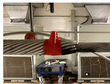
(c) Acelerômetro da ponta direita da emenda - Ensaio 3.
