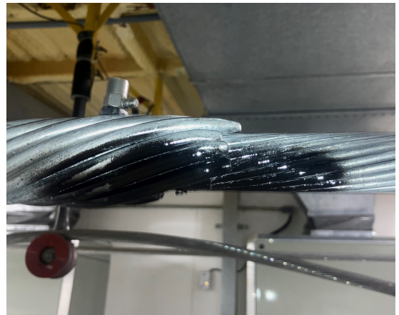
(b) Ponta direita da emenda marcada por tinta antes - Ensaio 3.
