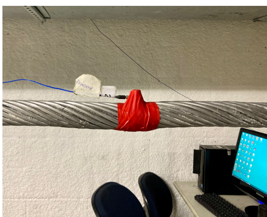
(a) Acelerômetro no centro da emenda - Ensaio 3.
