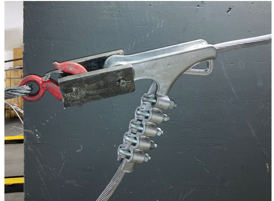
(b) Grampo de ancoragem próximo à talha de alavanca.
