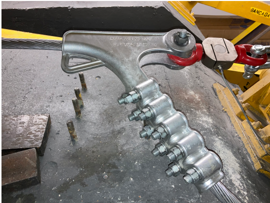
(a) Grampo de ancoragem próximo à célula de carga.
