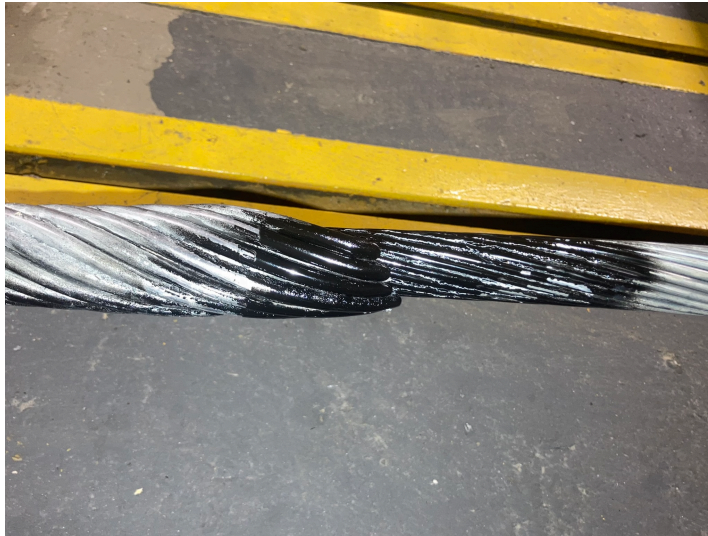
Figura 3.13 – Extremidade da emenda pintada em tinta spray preta.
