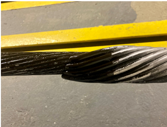
(a) Ponta esquerda da emenda marcada por tinta antes - Ensaio 3.
