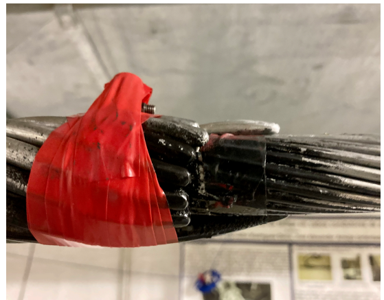
(d) Ponta direita da emenda marcada por tinta depois - Ensaio 3.
