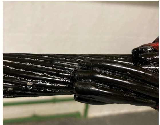
(b) Ponta da emenda marcada por tinta depois do Ensaio 5.
