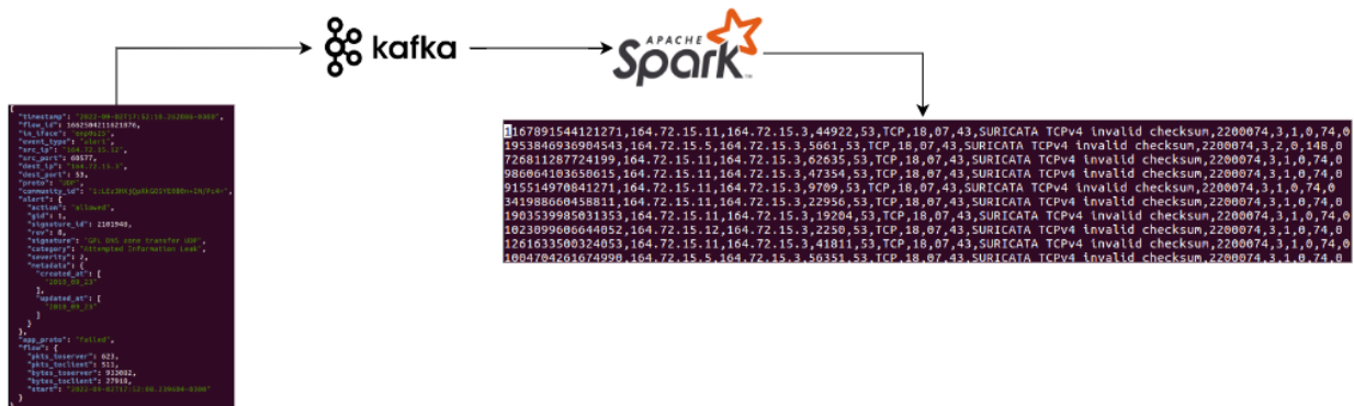
Figura 3.29 – Diagrama do processamento e transformação dos logs .
