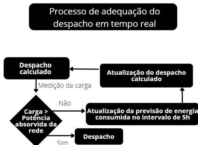
Figura 3.12: Fluxograma do processo de adequação do despacho
