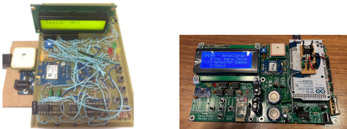
Figura 2.1: Primeira versão da Caixa Preta (imagem da esquerda) e segunda versão (imagem da direita), com dimensão 13 x 20 cm
