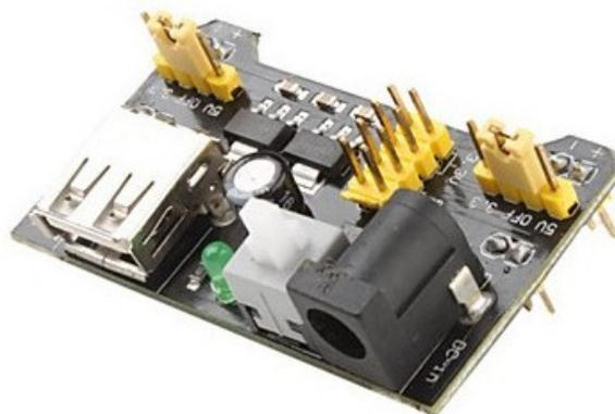
Figura 3.9: Fonte de Alimentação 5V/3,3V para *Protoboard*.
