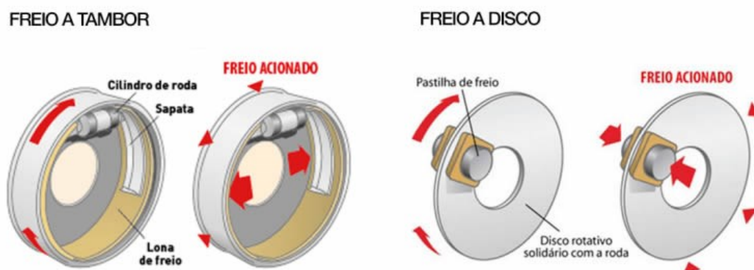
Figura 10 – Tipos de sistemas de freio automotivo. Fonte: Google imagens.
