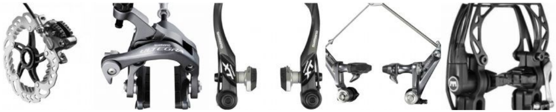
Figura 11 – Tipos de sistema de freio em bicicletas. Fonte: Pedal, 2008.
