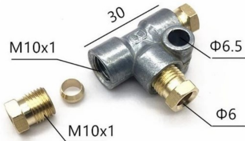
Figura 54 – Conector de 3 vias para freios hidráulicos. Fonte: Google imagens.
