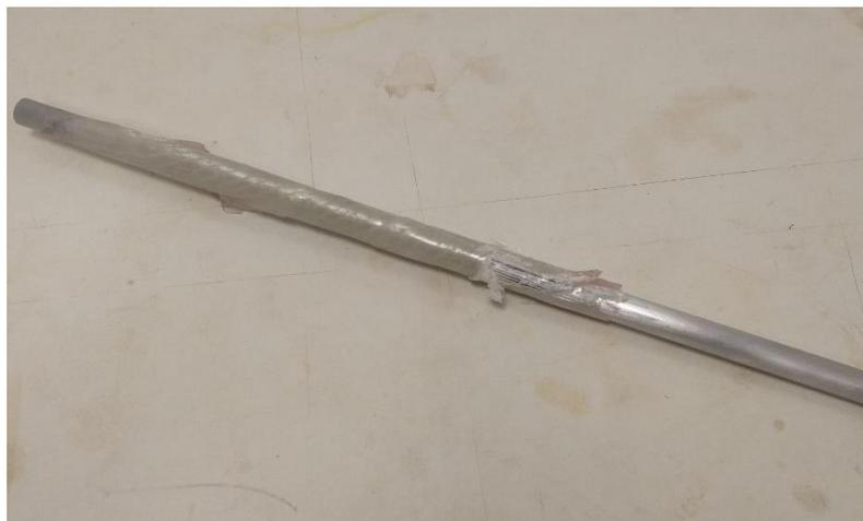
**Figura 19** - Tubo com avarias após tentativa de remoção do molde.
