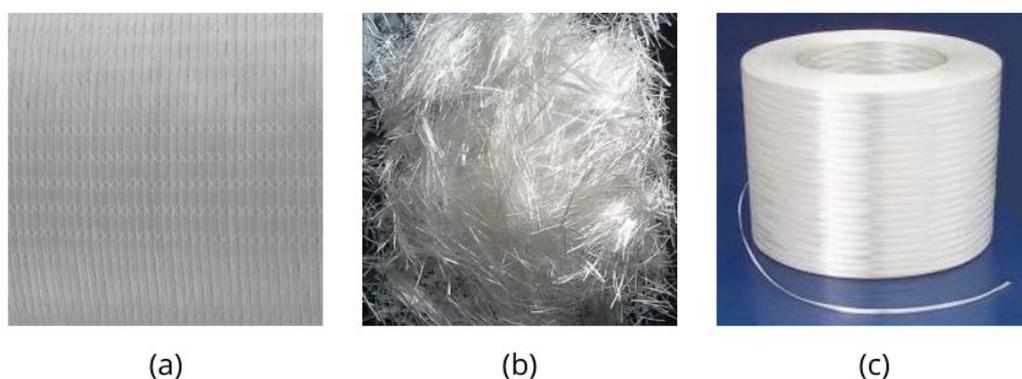
**Figura 5** – Formas da fibra de vidro: (a) Tecido. (b) Fibra picada. (c) Fibras. Fonte: (a) ([E-composites](#), 2022). (b) ([Telhaseco](#), 2022). (c) ([Cpicfiber](#), 2022).
