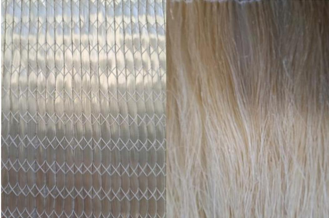
**Figura 22** - Comparação entre o alinhamento das fibras de vidro e sisal.
