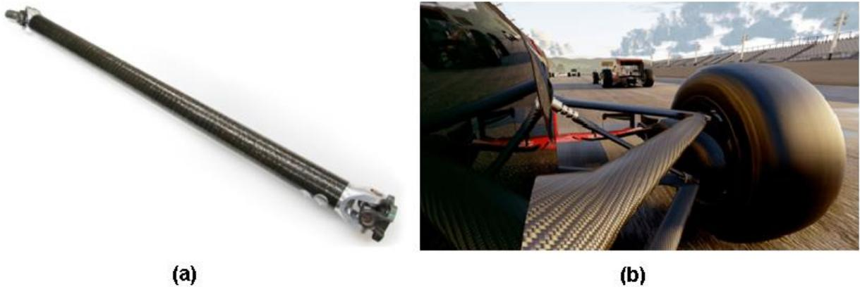
**Figura 10** – Aplicação de tubos de compósitos: (a) Semi-eixo. (b) Conjunto de suspensão da Fórmula 1. Fonte: (a) ([worksmotorsports](https://www.worksmotorsports.com), 2022). (b) ([Tapscape](https://www.tapscape.com), 2022)
