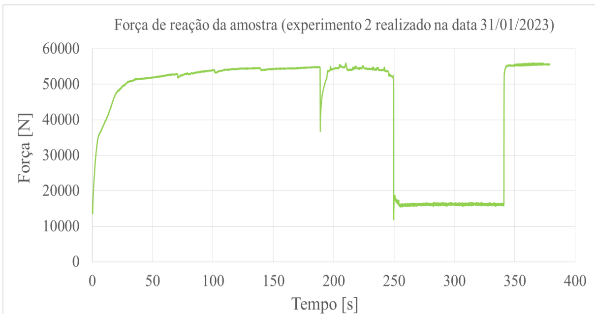
Figura 73. Curva Força x Tempo do quarto ensaio com CP utilizando o dispositivo RoofCrush. (Fonte: autoria própria)
