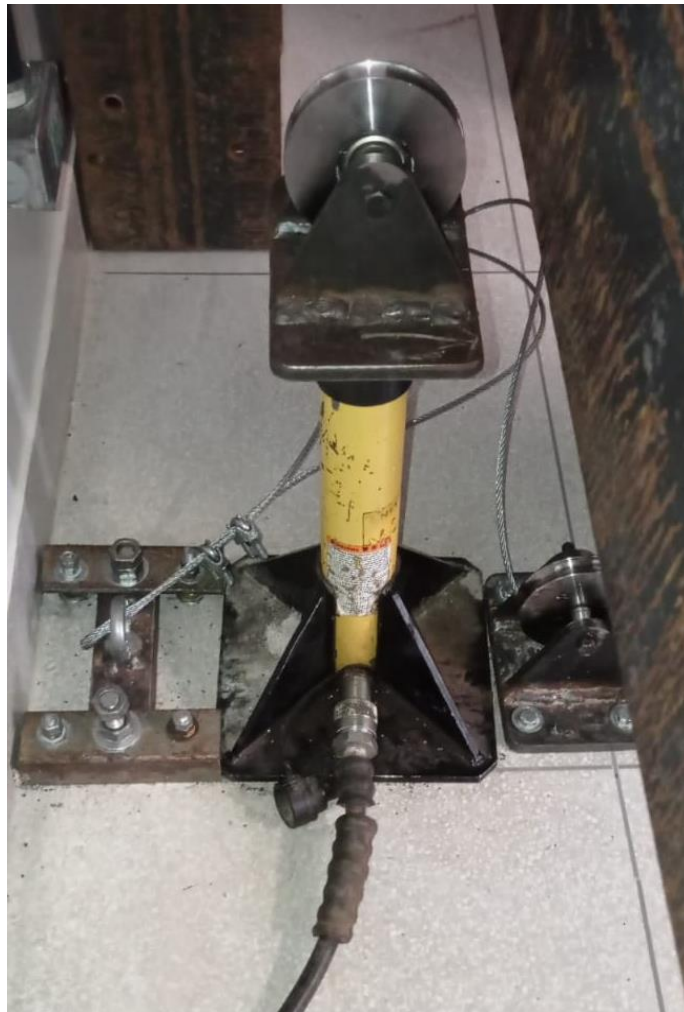
Figura 31. Montagem final do sistema de contrapesos para retorno da placa. (Fonte: autoria própria)
