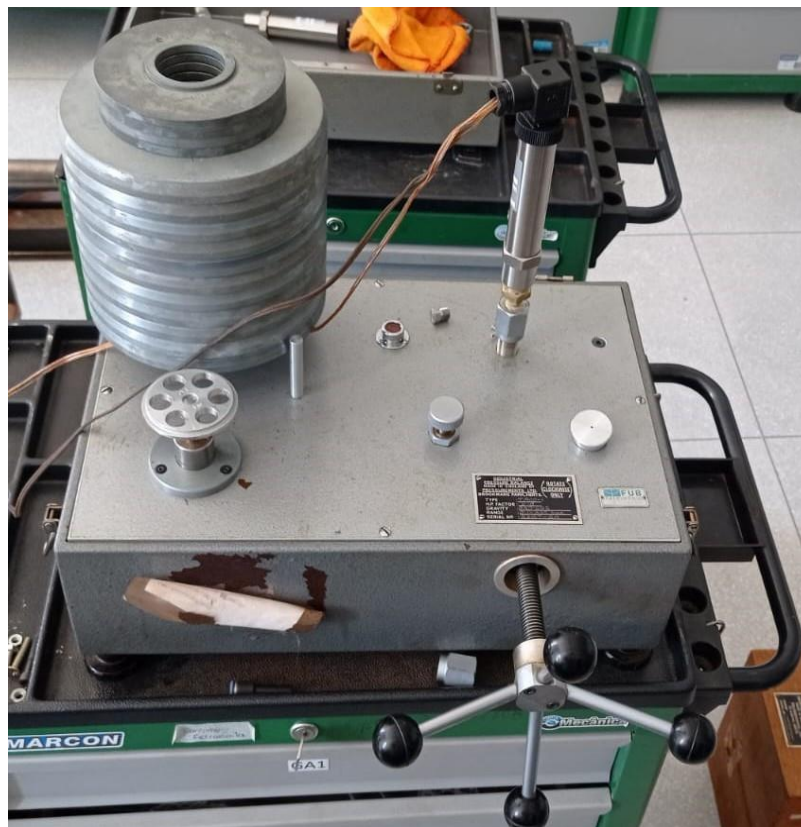
Figura 21. Montagem do transdutor de pressão GTP 1000 na Balança de Pressão. (Fonte: autoria própria)
