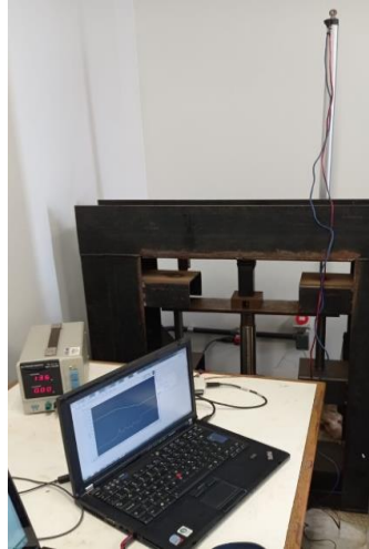
Figura 29. Configuração do ensaio preliminar com a máquina de CrashBox. (Fonte: autoria própria)
