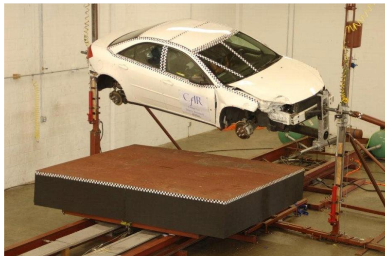
Figura 14. Configuração inicial do teste dinâmico Jordan Rollover System. (Fonte: [31])
