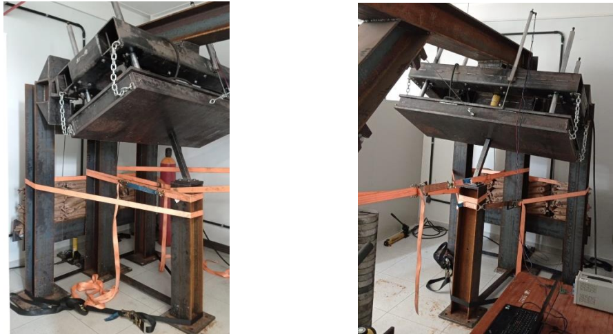
Figura 58. Configuração/arranjo de cintas utilizado para fixar o corpo de prova no Ensaio do dia 31/01/2023.
