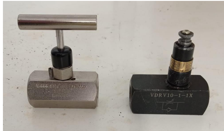
Figura 56. Válvulas de restrição de fluxo para realizar o controle de velocidade da placa.
