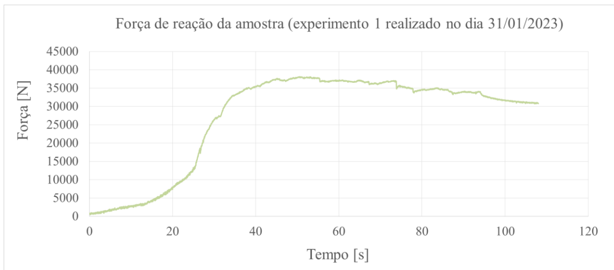
Figura 70. Curva Força x Tempo do terceiro ensaio com CP utilizando o dispositivo RoofCrush. (Fonte: autoria própria)
