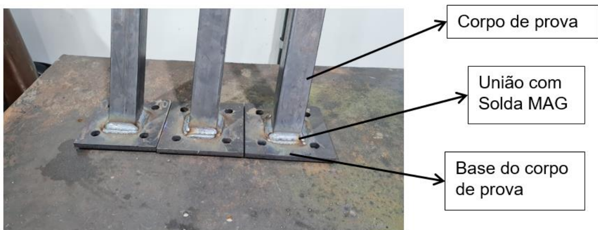
Figura 57. Novas amostras confeccionadas utilizando a solda MAG para conexão entre o corpo de prova e a base.
