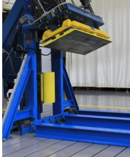
Figura 7. Dispositivo utilizado nos Roof Crush Test da NHTSA e IIHS fornecido pela MGA Research Corporation. (Fonte: [20])
