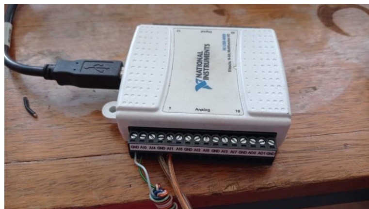
Figura 32. Placa de aquisição de dados da National Instruments (Fonte: autoria própria)
