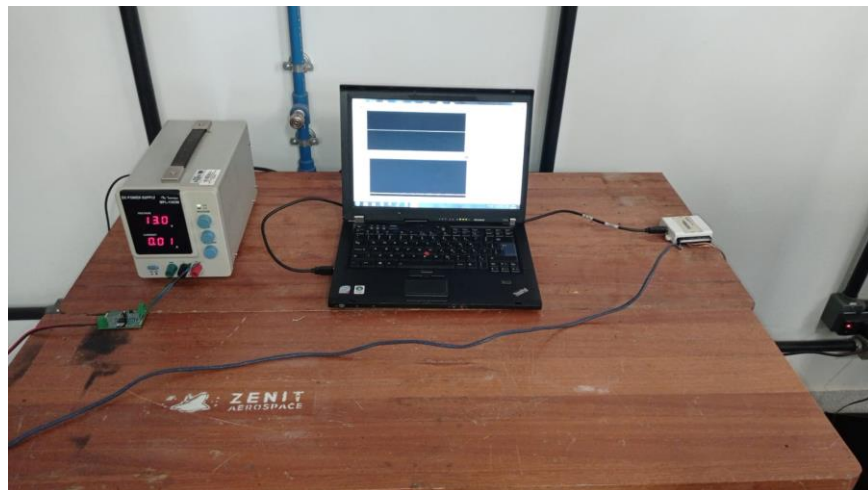
Figura 93. Sistema para de aquisição de dados para o ensaio. (Fonte: autoria própria)
