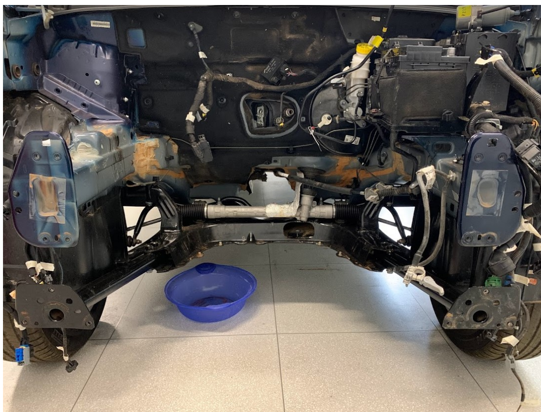
Figura 42 – Cofre do veículo após a remoção dos sistemas de powertrain e drivetrain
