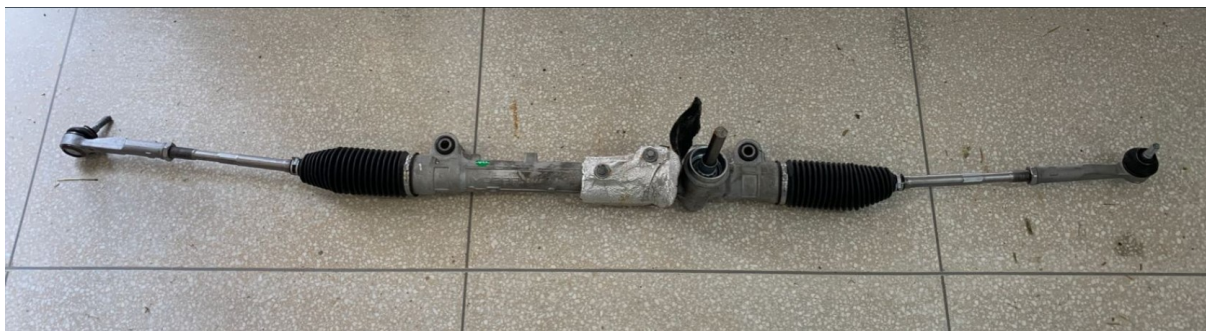
Figura 29 – Caixa de direção extraída do veículo.
