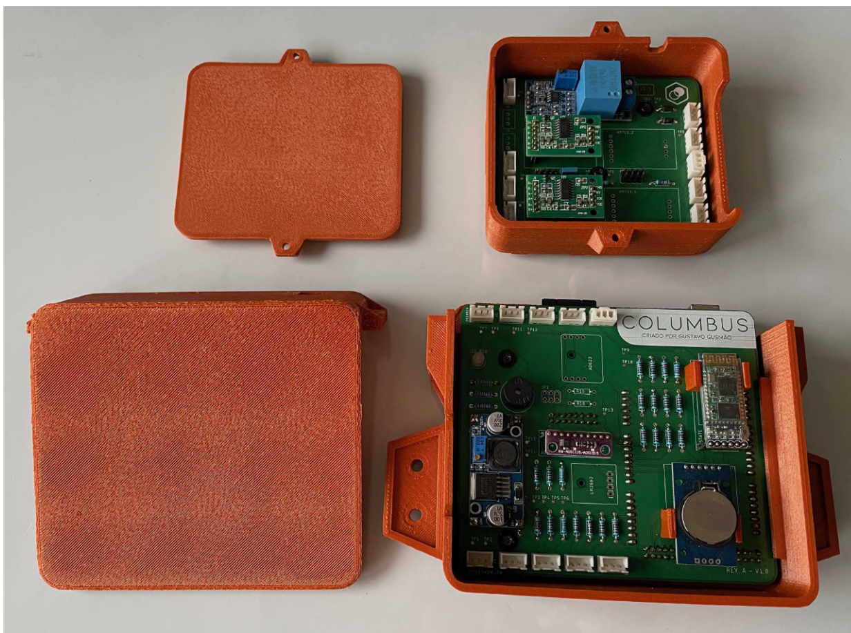
Figura 59 – Caixas de proteção impressas em processo FDM.
