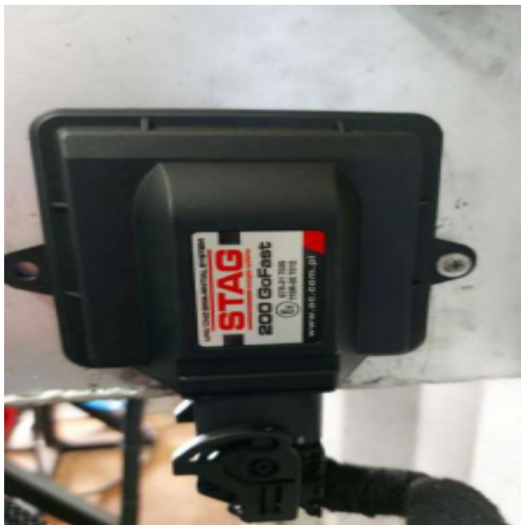
Figura 15 – Unidade de controle eletrônica do Kit Gás
