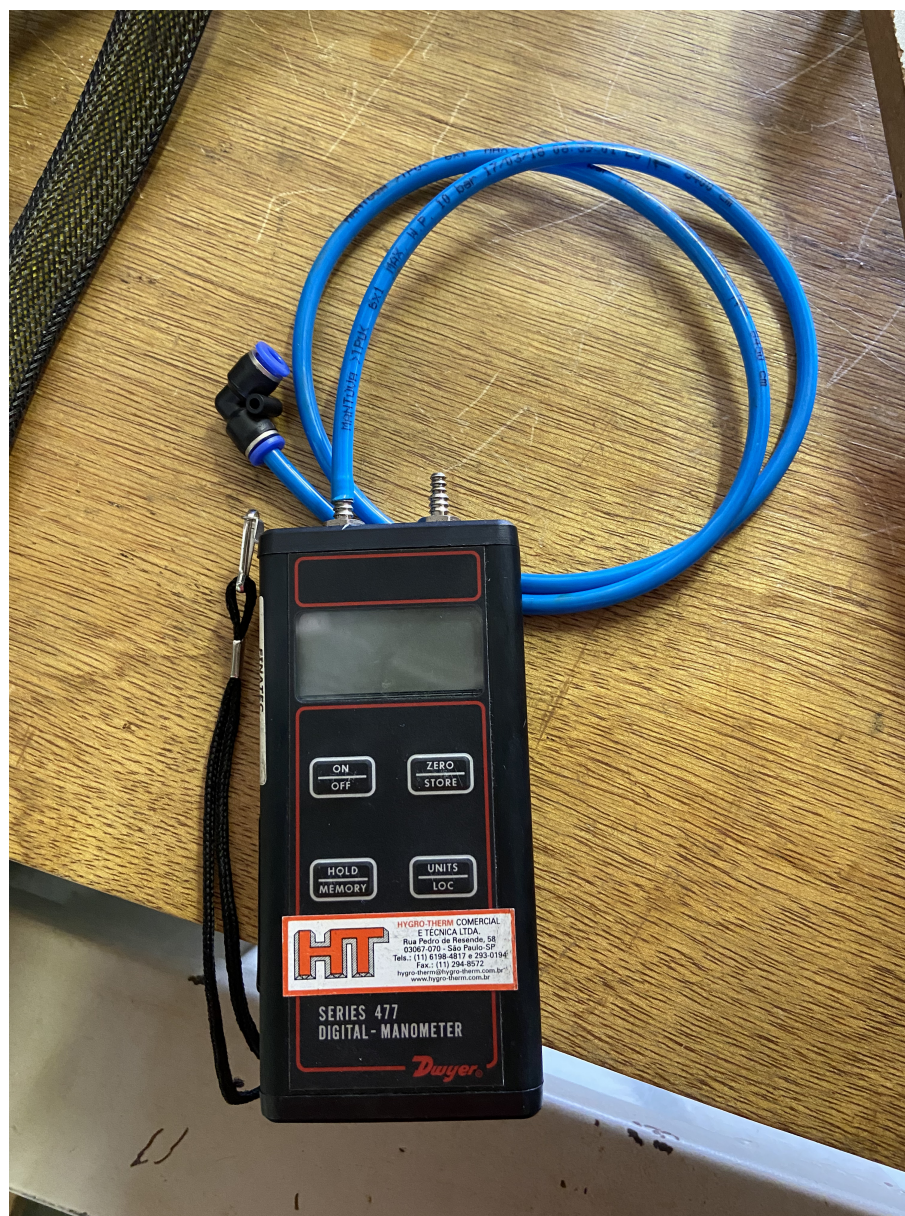
Figura 17 – Manômetro digital utilizado no experimento
