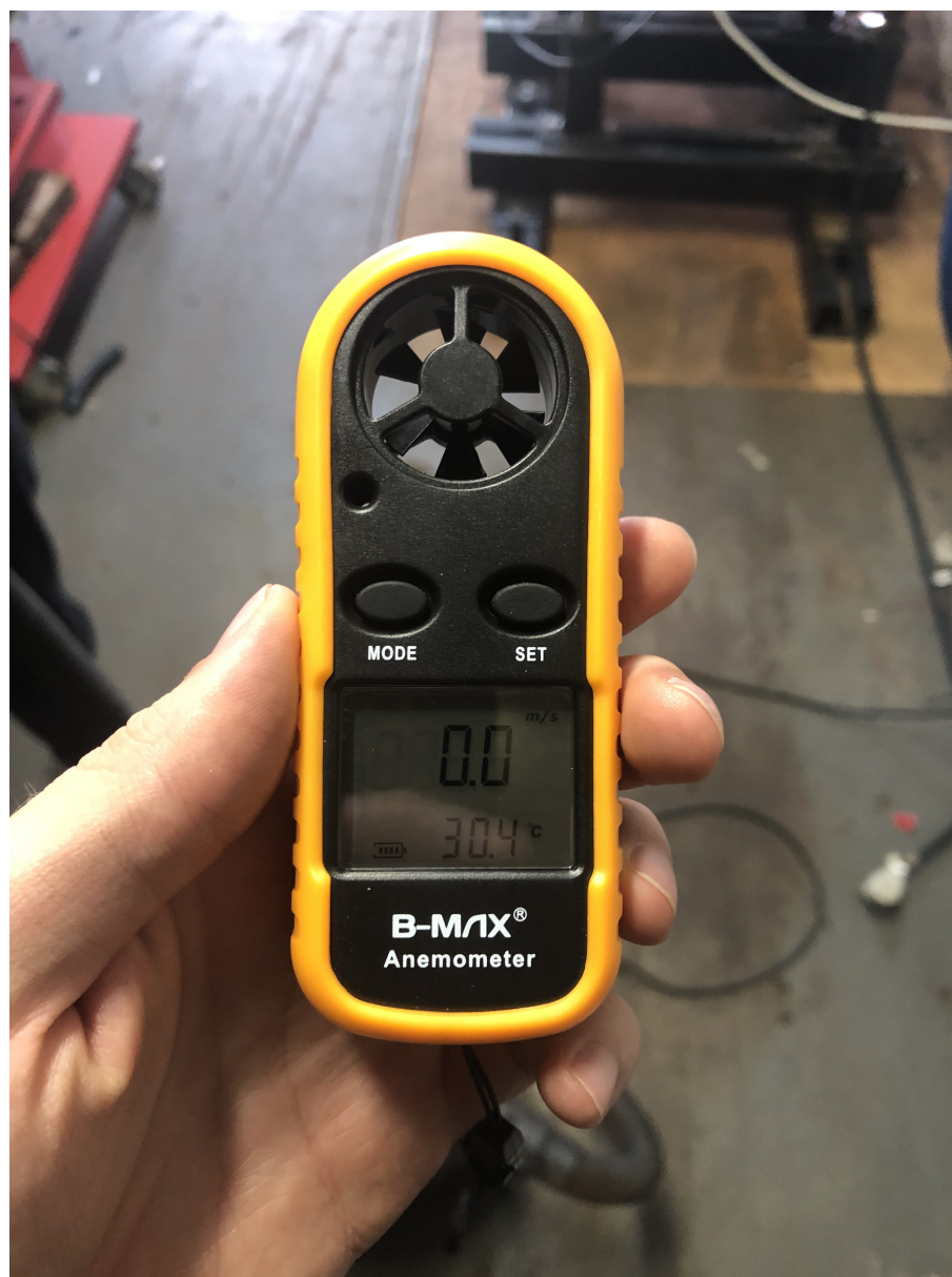
Figura 18 – Anemômetro utilizado para medir velocidade
