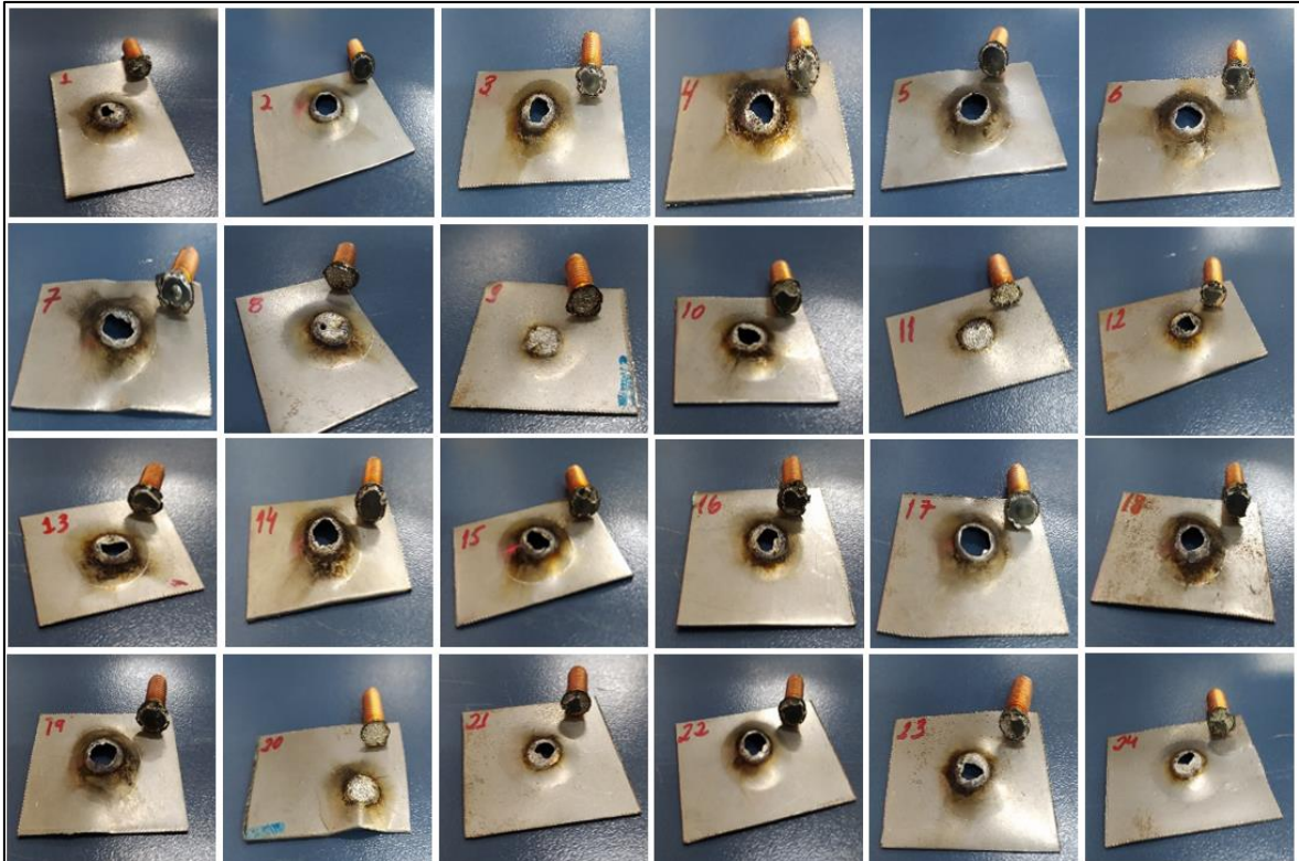
Figura 25: Resultados visuais dos testes de tração para cada combinação de parâmetros. Fonte: Autor (2022)
