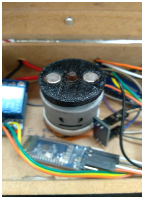
Figura 7 - Motor acoplado a um disco com dois ímãs de neodímio.
