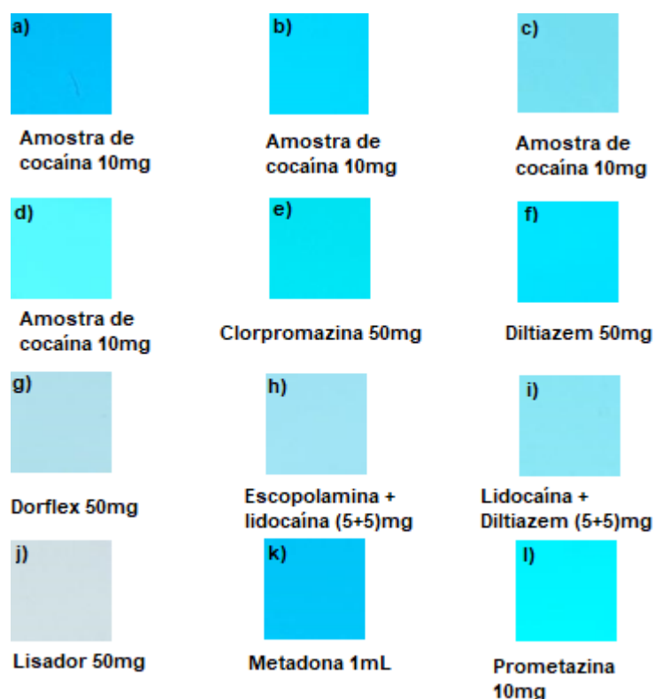
Figura 8. Imagens da fase orgânica do Teste de Scott selecionadas das fotos obtidas pelo desenvolvido para 12 amostras distintas.
