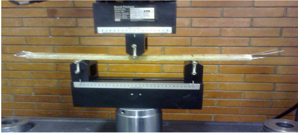
Figura 2.4 – Ensaio de flexão de uma viga produzida
