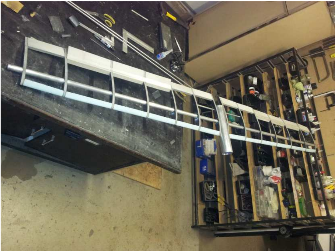
Figura 7-3 Asa em construção
