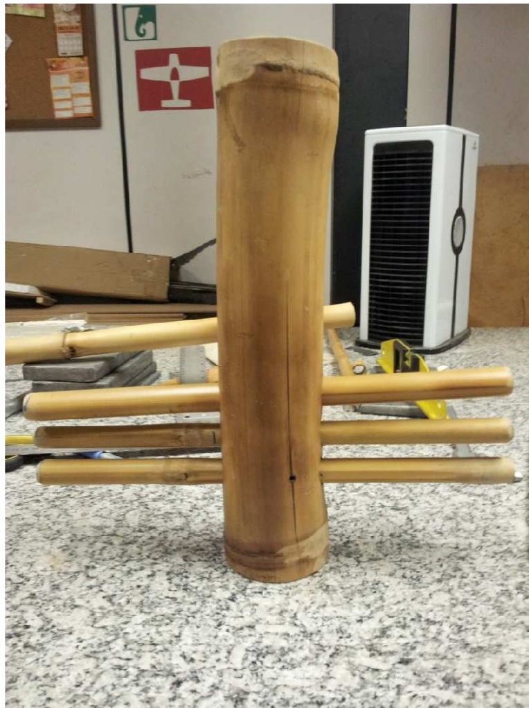
Figura 7-19 Fixação da asa de materiais alternativos + corpo do avião
