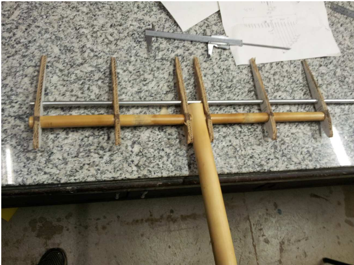
Figura 7-21 Construção profundor materiais alternativos
