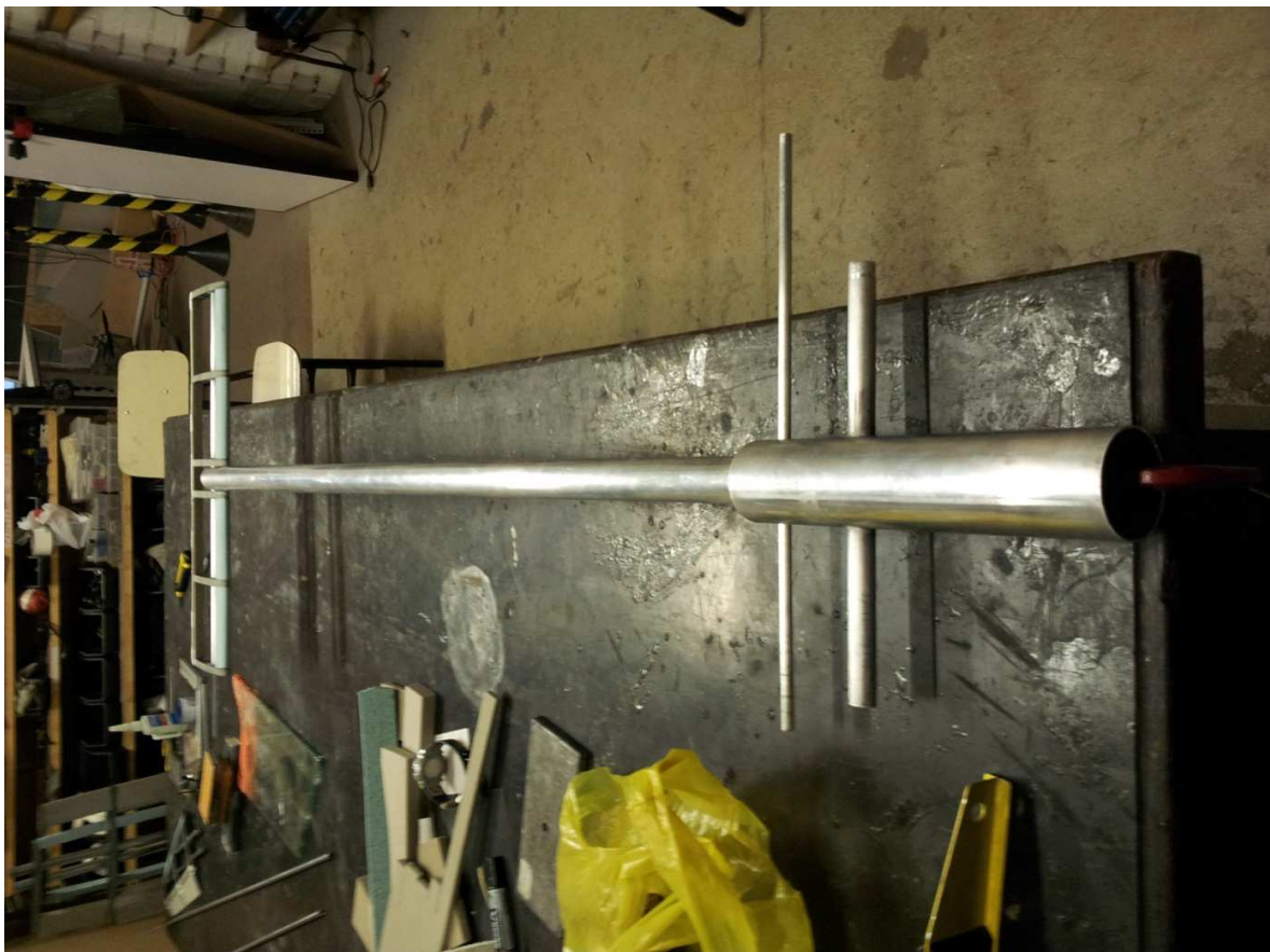
Figura 7-8 Fixação da asa
