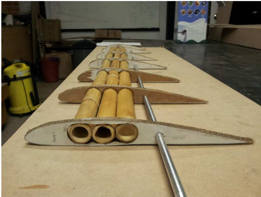
Figura 7-16 Asa em construção
