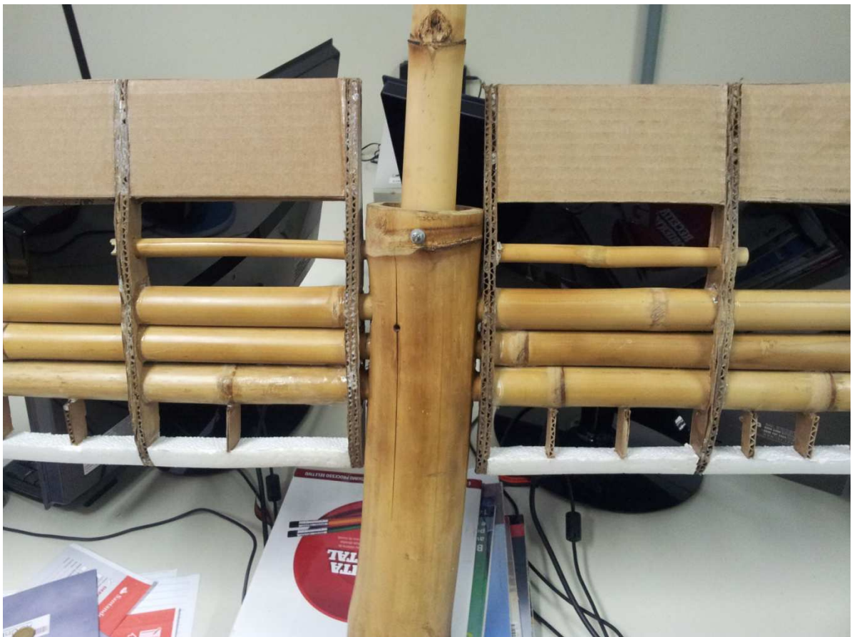
Figura 7-25 Fixação central da asa de materiais alternativos
