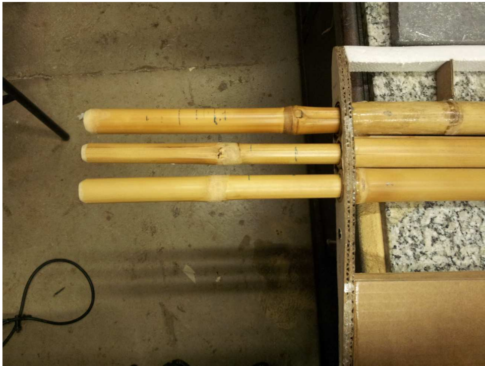
Figura 7-18 Fixação da asa de materiais alternativos
