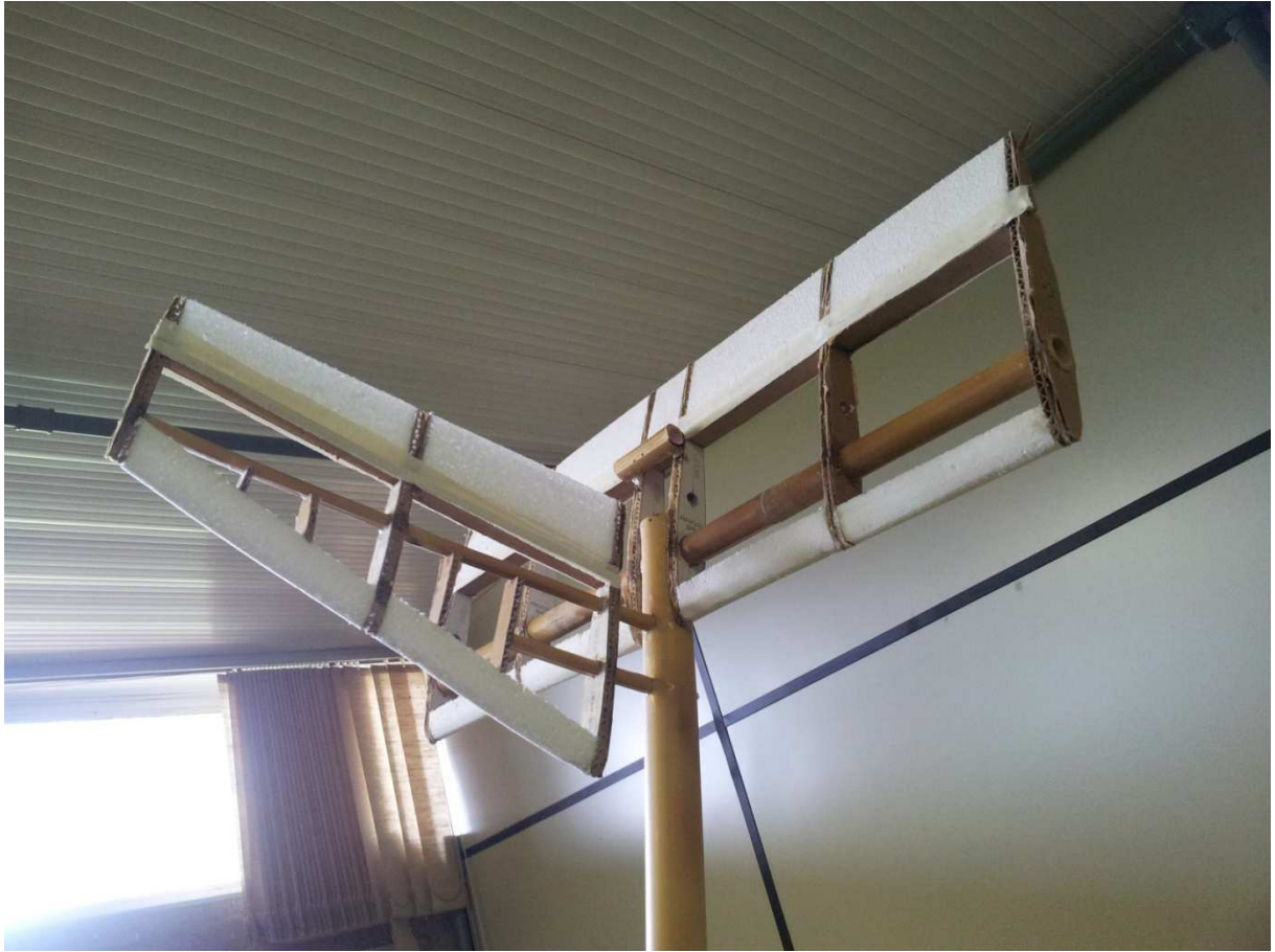
Figura 7-26 Montagem leme + Profundor materiais alternativos
