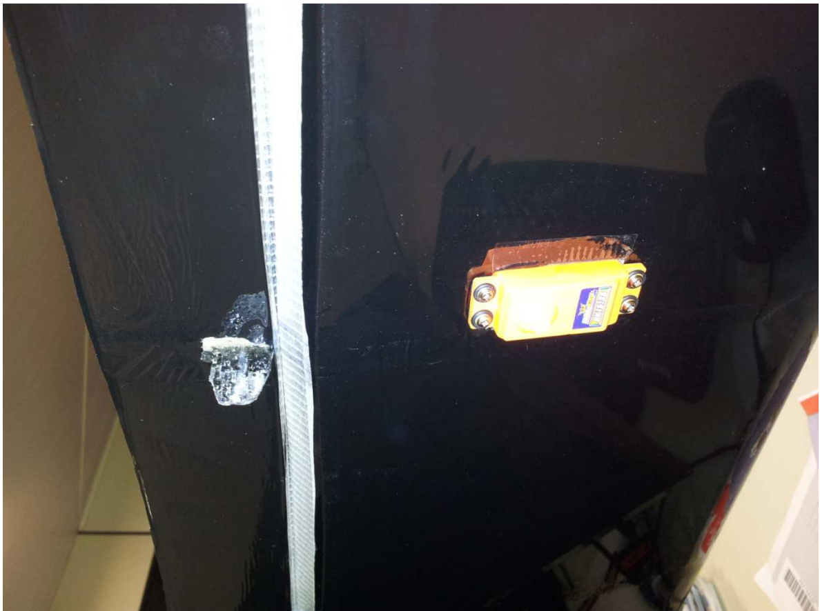
Figura 7-12 Detalhe da fixação dos servos na asa
