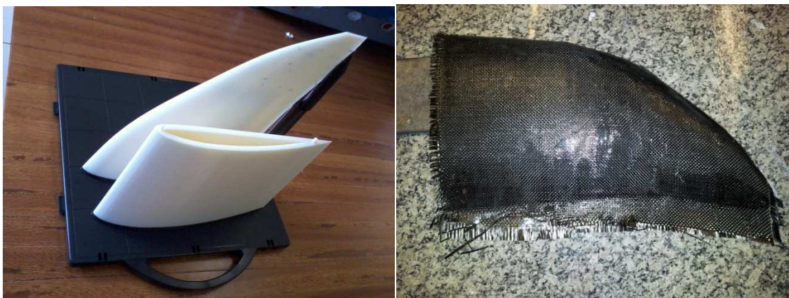
Figura 7-6 Molde para confecção das pontas das asas e laminação da ponta de fibra de carbono
