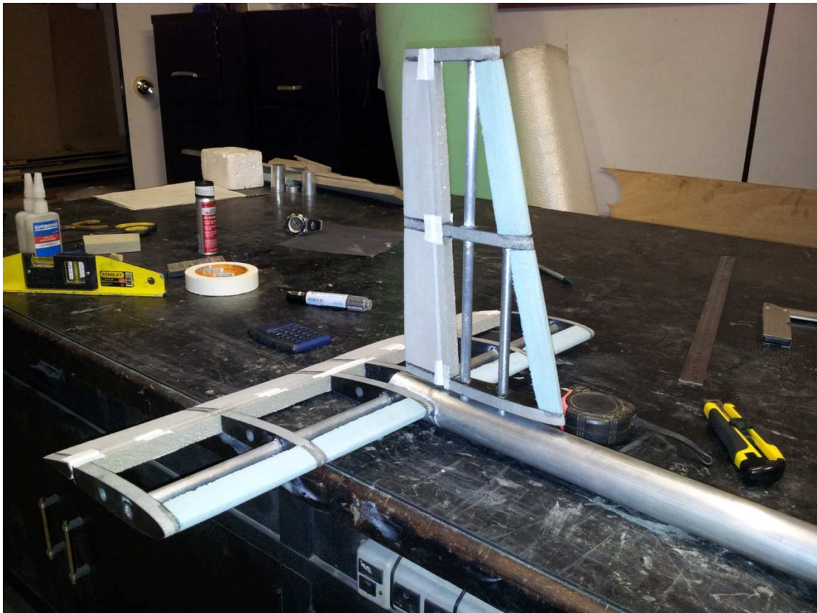
Figura 7-7 Montagem do profundor e do leme
