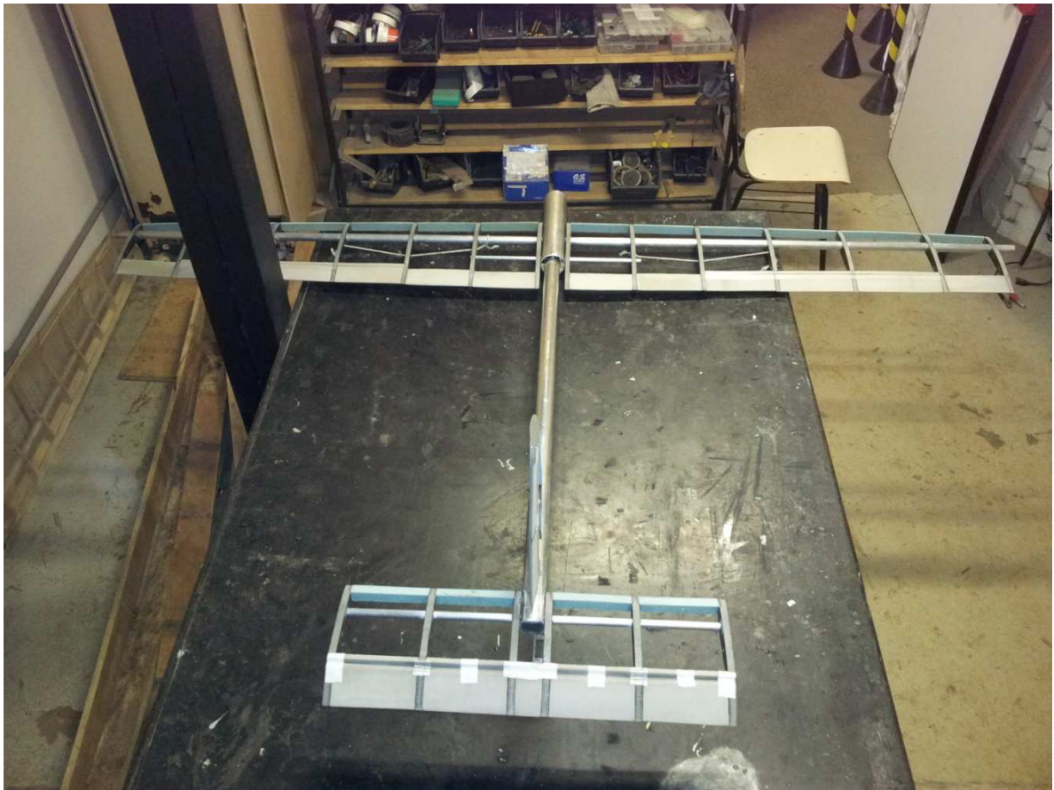
Figura 7-9 Montagem do avião sem as pontas de asa e entelagem
