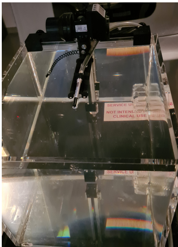
Figura 30 – Arranjo experimental para fator de calibração (output) de fótons
