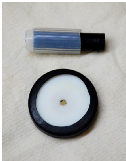
Figura 36 – Engrenagens cobertas com borracha para servir como roletes.
