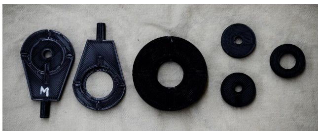
Figura 25 – Alinhadores em suas peças separadas. Da esquerda para a direita: base montada com disco de furo desalinhado, base sem disco, base do suporte em frente à fonte sem disco, discos de diferentes furos.
