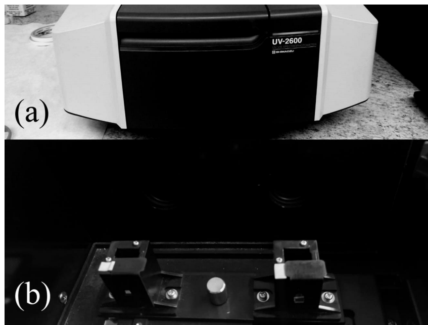
Figura 6 – Espectrofotômetro de UV-Vis. (a) visão frontal. (b) suportes com o substrato na esquerda e com a amostra na direita. Fonte: própria.
