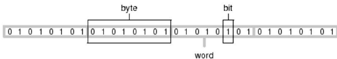
Figura 4 – Formato de armazenamento em bits, bytes e word.
