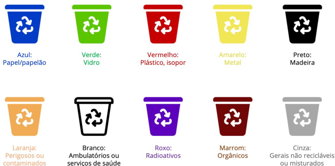
Figura 1: Cores utilizadas nos contêineres, indicando o tipo de resíduo (segundo a Resolução Conama n°275/2001).
