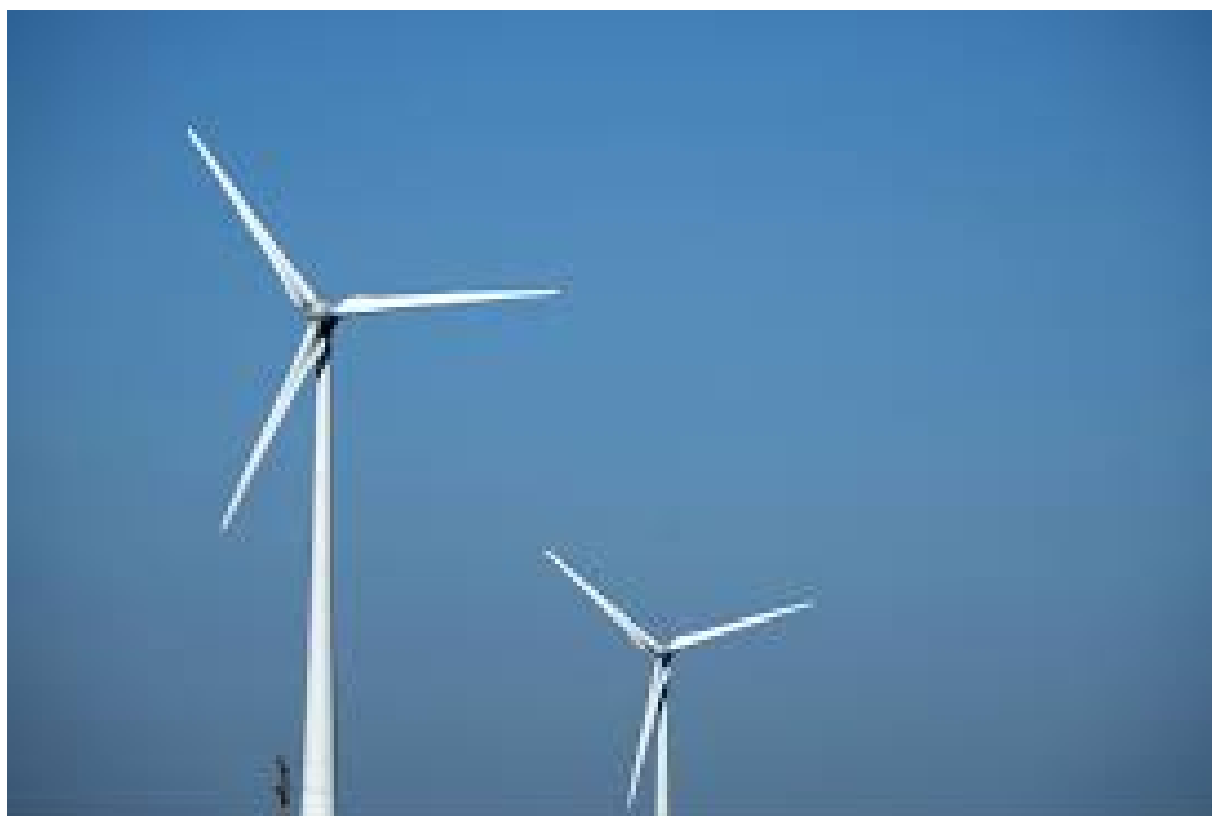
Figura 14 – Aerogerador de Eixo Horizontal
