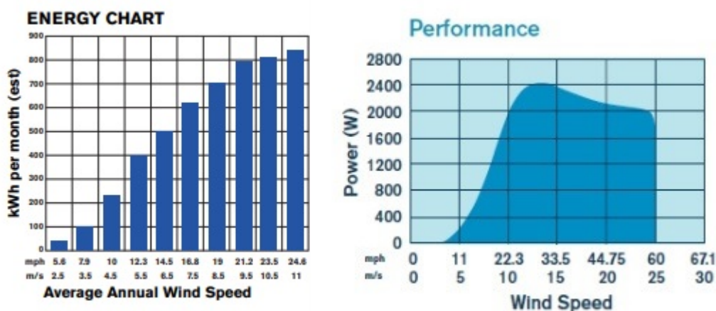
Figura 4 – Curva de Potência e Expectativa de Geração do Aerogerador Skystream 3.7 - 1,9kW.
