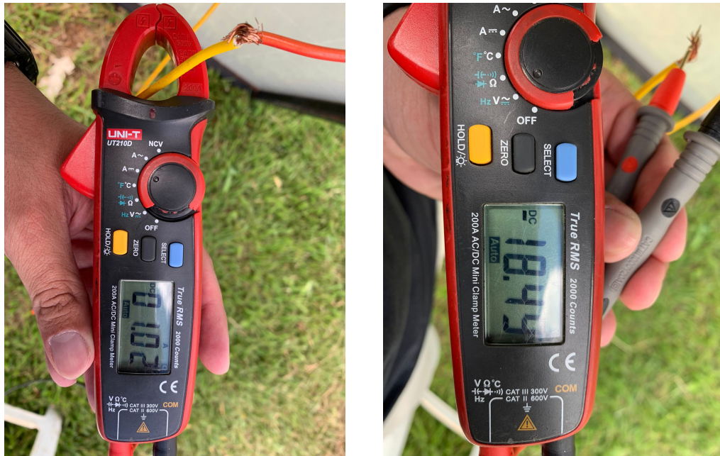
Figura 25 – Ensaio de curto circuito e medição da tensão de circuito aberto no módulo KD135SX-UPU.
