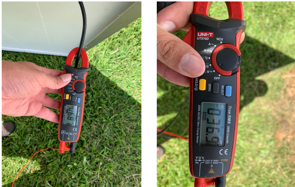
Figura 28 – Ensaio de curto circuito e medição da tensão de circuito aberto no módulo JKM440M-6TL4-V.
