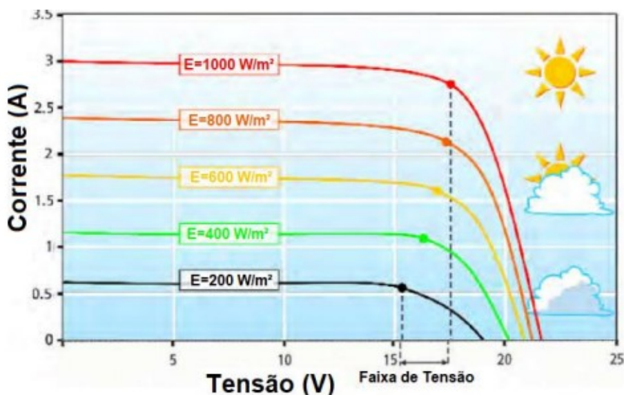
Figura 3 – Corrente versus tensão de um módulo fotovoltaico para diferentes irradiações.
