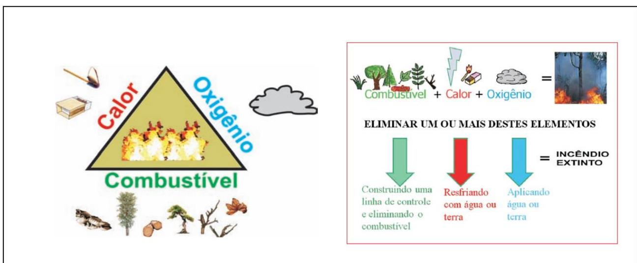
**Figura 1:** Elementos do Triângulo do Fogo. Fonte: ICMBio, 2010.
