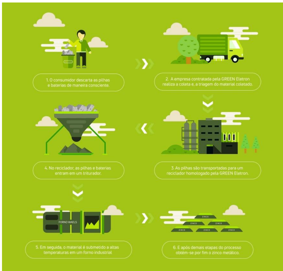
Figura 8 – Esquema de coleta e reciclagem das pilhas coletadas pela Green Eletron (Fonte: Cartilha Informativa Green Reciclapilha, 2019)
