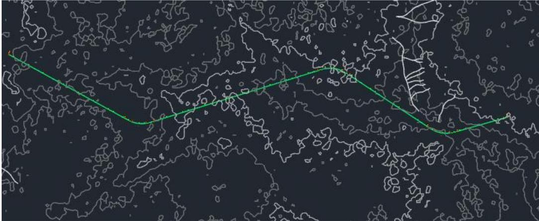
Figura 4.19 – Resultado do alinhamento desenhado após a inserção das curvas
