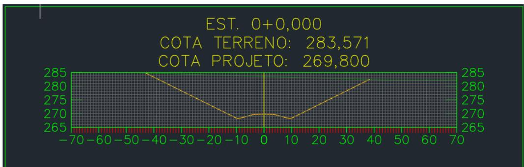
Figura 4.43 – Vista da seção transversal na estaca 0+0,000
