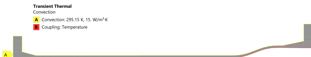
Figura 22 – Indicação das condições de contorno de convecção e de acoplamento para a seção do aquecedor.
