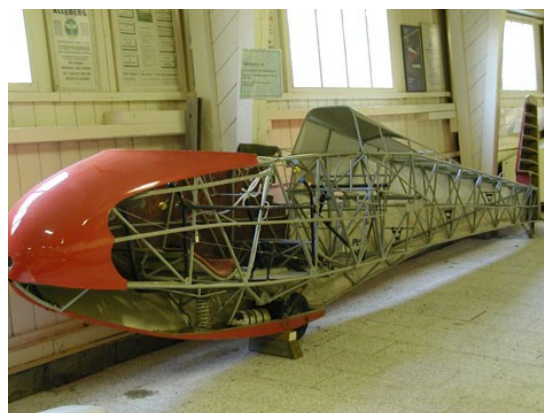
(b) Bergfalke III fuselagem
