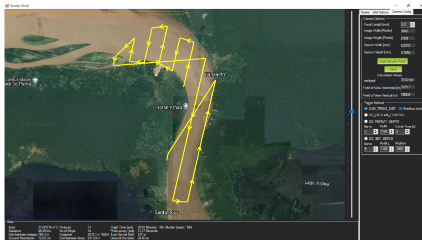
Figura 14 – Plano de voo para faixa de leito em 5 km Fonte: Autoria própria
