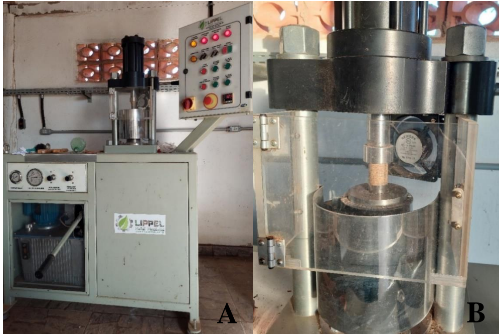
Figura 5 – Produção dos briquetes. A – Briquetadeira Lippel LB 32. B – Briquete produzido em resfriamento.
