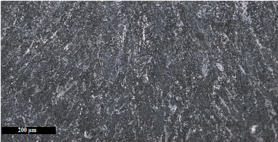
Figura Apêndice B.7 – Microestrutura Inferior da amostra A com ampliação com lente de 20x.
