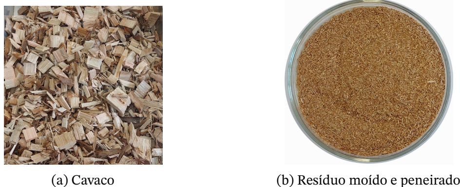
Figura 12 – Preparo do material cavaco de Eucalyptus Sp.
