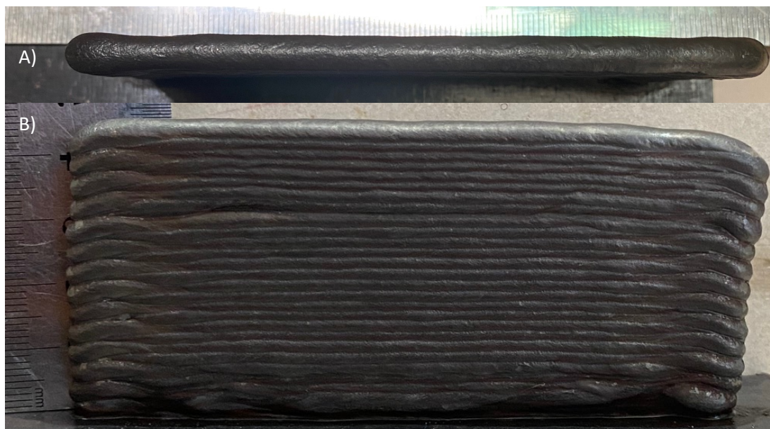
Figura 63 - Vista superior (A) e lateral (B) da parede com temperatura de interpasse controlada.
