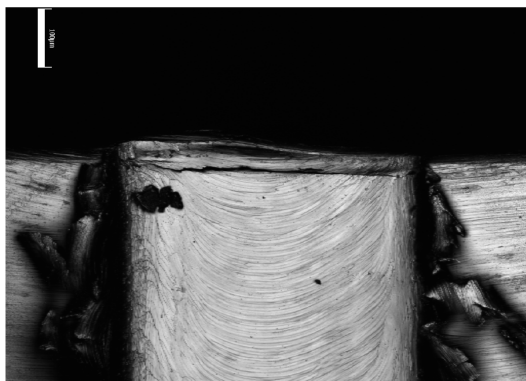
(a) Antes da rebarbação
