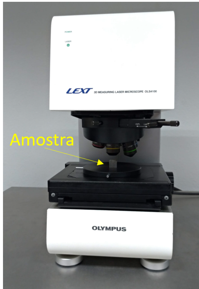
Figura 31 – Microscópio utilizado no experimento com amostra posicionada, para levantamento das variáveis de saída.
