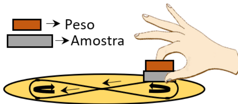
Figura 30 – Esquema do processo de polimento manual.
