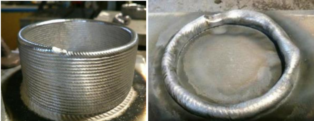
Figura 21 Peça obtida ao modificar parâmetro elétricos e base obtida através da dissipação de calor (Silva, 2017)
