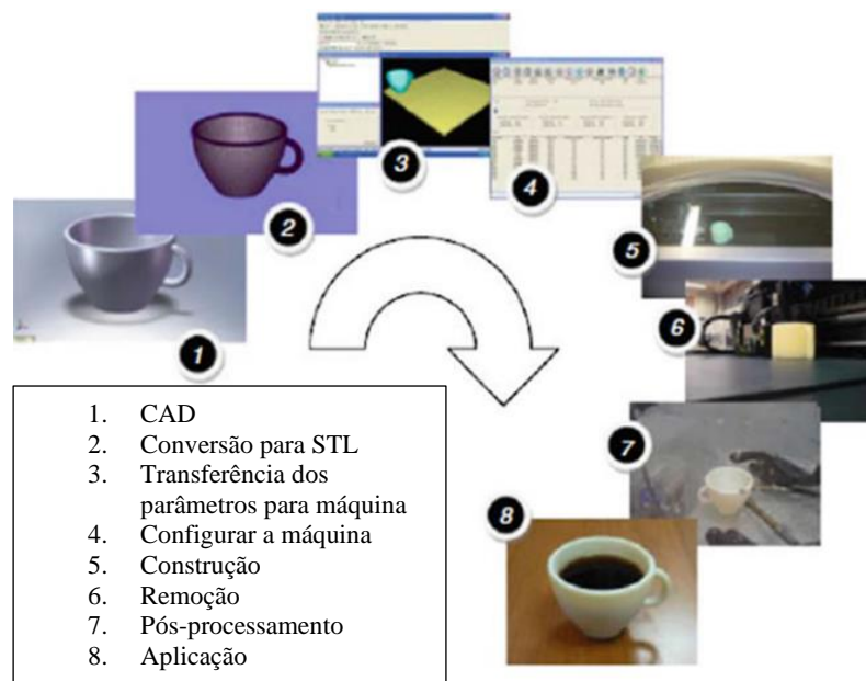
Figura 12 Etapas do processo de MA (Gibson, et al., 2010)
