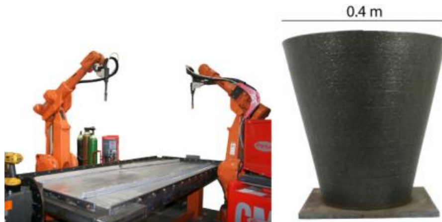
Figura 17 (a) longarina fabricada por processo CMT pulso avançado e em (b) cone truncado em aço macio fabricado por processo CMT convencional (FRONIUS, 2015).
