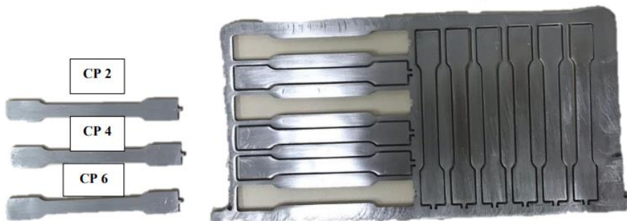
Figura 64 Corpos de prova selecionados para teste de rugosidade
