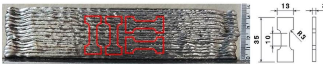
Figura 36 Corpo de prova padrão para realização do ensaio de tração (Silva, et al., 2018)
