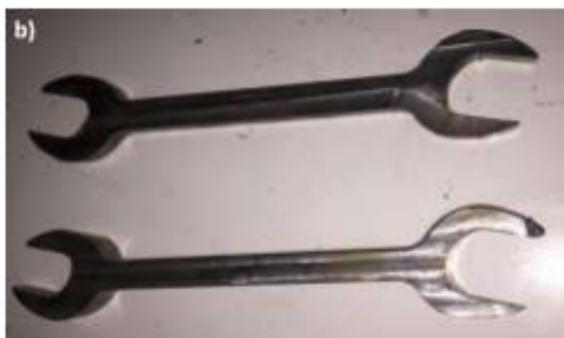
Figura 7 – a) e b) - Peças obtidas por MA com o arame ER70S-6 após um processo de usinagem. Fonte: (CERVANTES et al., 2019)
