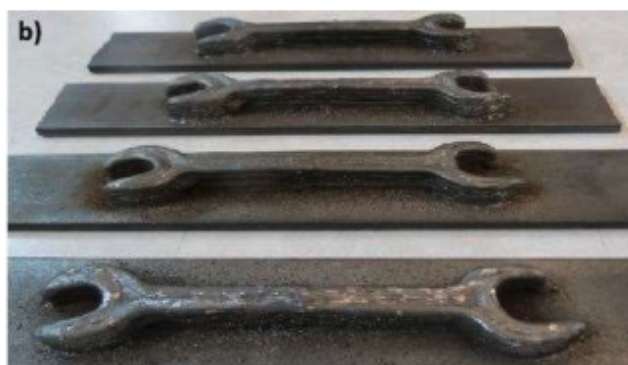
Figura 6 – a) e b) - Peças obtidas por MA com o arame ER70S-6. Fonte: (CERVANTES et al., 2019)
