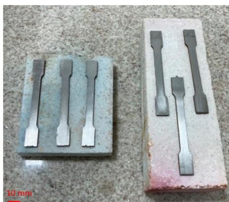
Figura 4.7: Corpos de prova retirados da peça depositada, prontos para o tratamento térmico de recozimento
