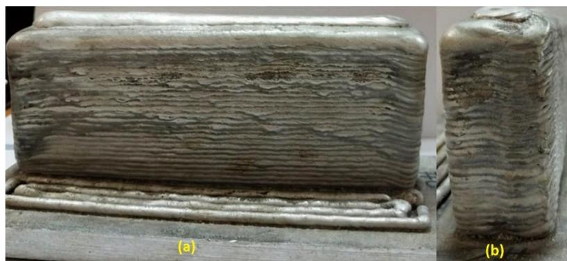
Figura 2.18: Peça produzida por manufatura aditiva por deposição a arco com um *advanced CMT* (a) vista frontal e (b) vista lateral (Geng et al. 2021).
