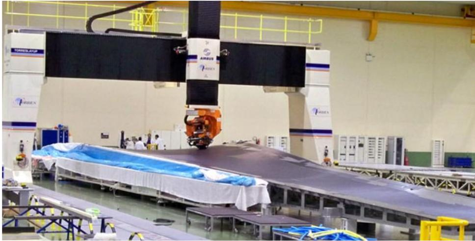
Figura 1.4: Asa impressa pela Embraer para estudos e prototipagem (Zutin 2021).
