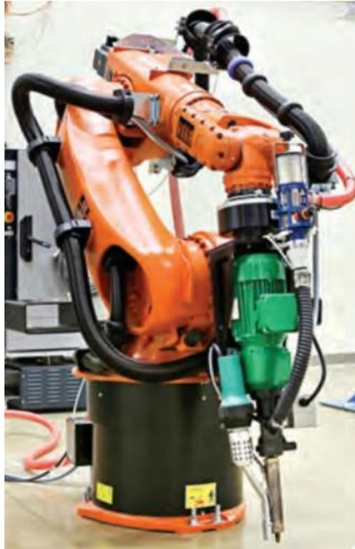
Figura 1.6: Braço robótico utilizado para o processo de BAAM (Holshouser et al. 2013).
