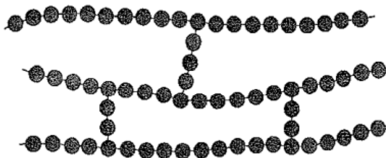
Figura 2.11 Representação de uma cadeia polimérica com ligações cruzadas.
