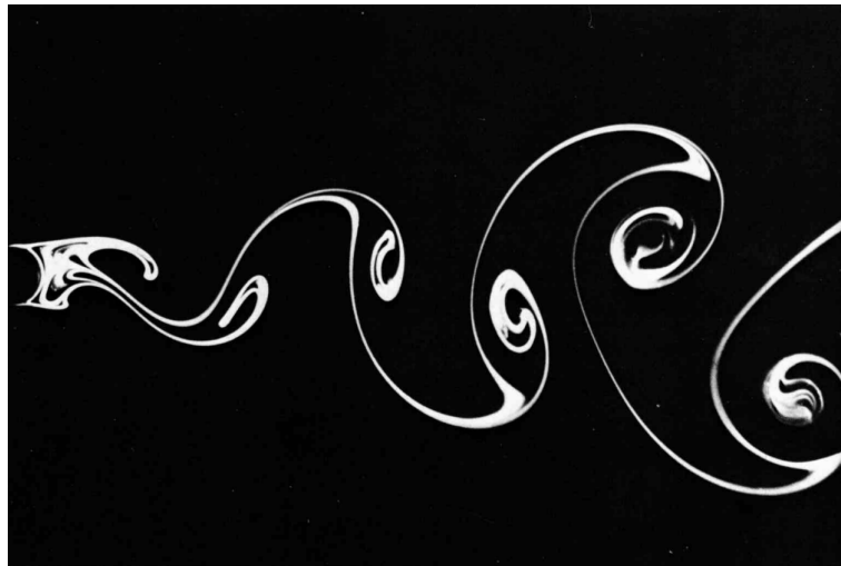
Figura 2.14: Esteira de vórtices de Von Kármán atrás de um cilindro circular sobre escoamento ( Re=140 ). Fonte: (DYKE, 1982)
