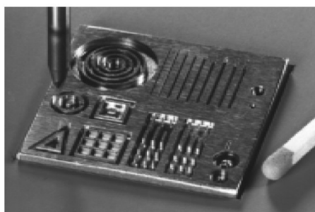
Figura 1.1: Microestruturas produzidas por corte através de uma microfresadora (MASUZAWA, 2000).
