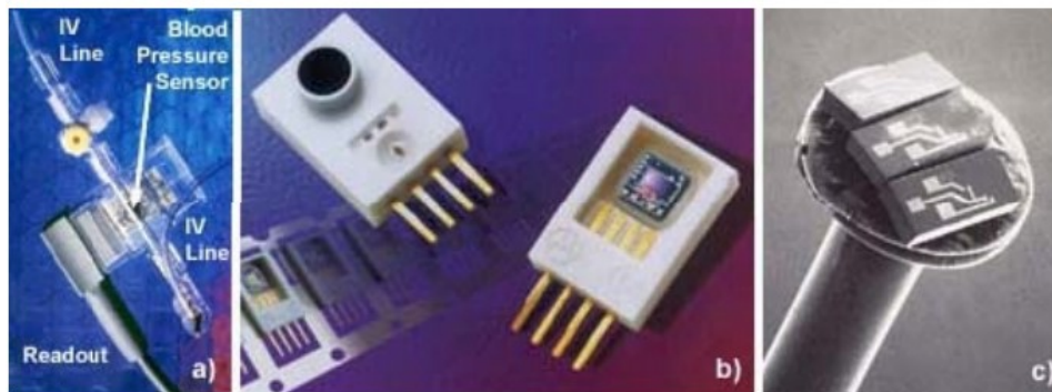
Figura 2.3: (a) Dispositivo de sensor de pressão sanguínea, (b) Dispositivo de sensor de pressão sanguínea, e (c) Sensores de ponta de cateter intra-cardial para monitorar a pressão arterial durante cateterismo cardíaco. (Fonte: MEMS and Nanotechnology Clearinghouse).
