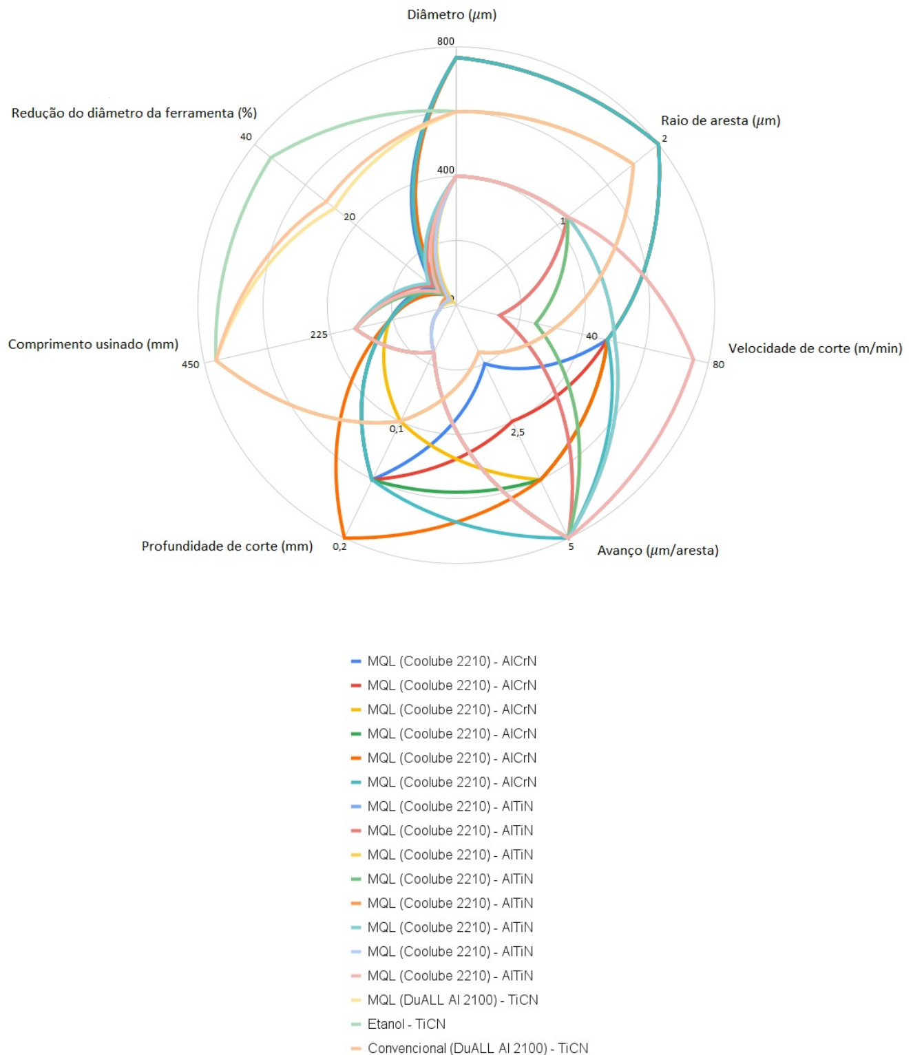
Figura 4.28: Redução do diâmetro de ferramenta diante seus respectivos parâmetros de corte com uso de lubrificantes.
