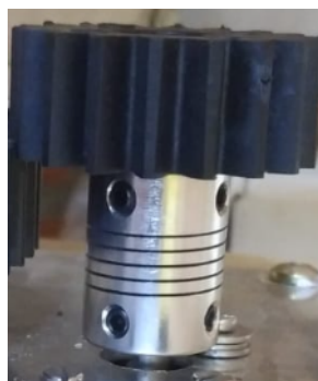
Figura 4.2: Eixo que transmite torque do motor para a engrenagem de 18 dentes.
