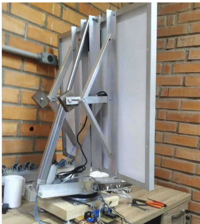
Figura 4.4: Haste de sustentação do painel fixada à chapa metálica e ao conjunto rolamento axial e engrenagem maior.
