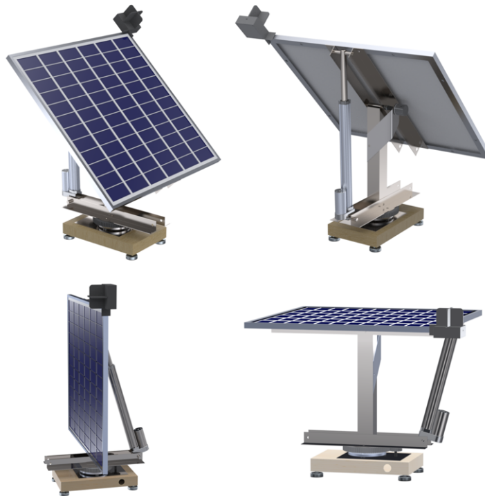
Figura 4.1: Projeto do rastreador. Note que na figura não foram desenhados os contrapesos
