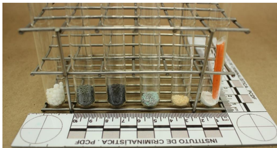
Figura 2. Exemplo de alguns materiais explosivos. Da esquerda para a direita: emulsão explosiva, pólvora balística, pólvora negra, pólvora pirotécnica, trinitrotolueno (TNT), tetranitrato de pentaeritritol (PETN) e cordel de PETN. Fonte: Autora, 2022.
