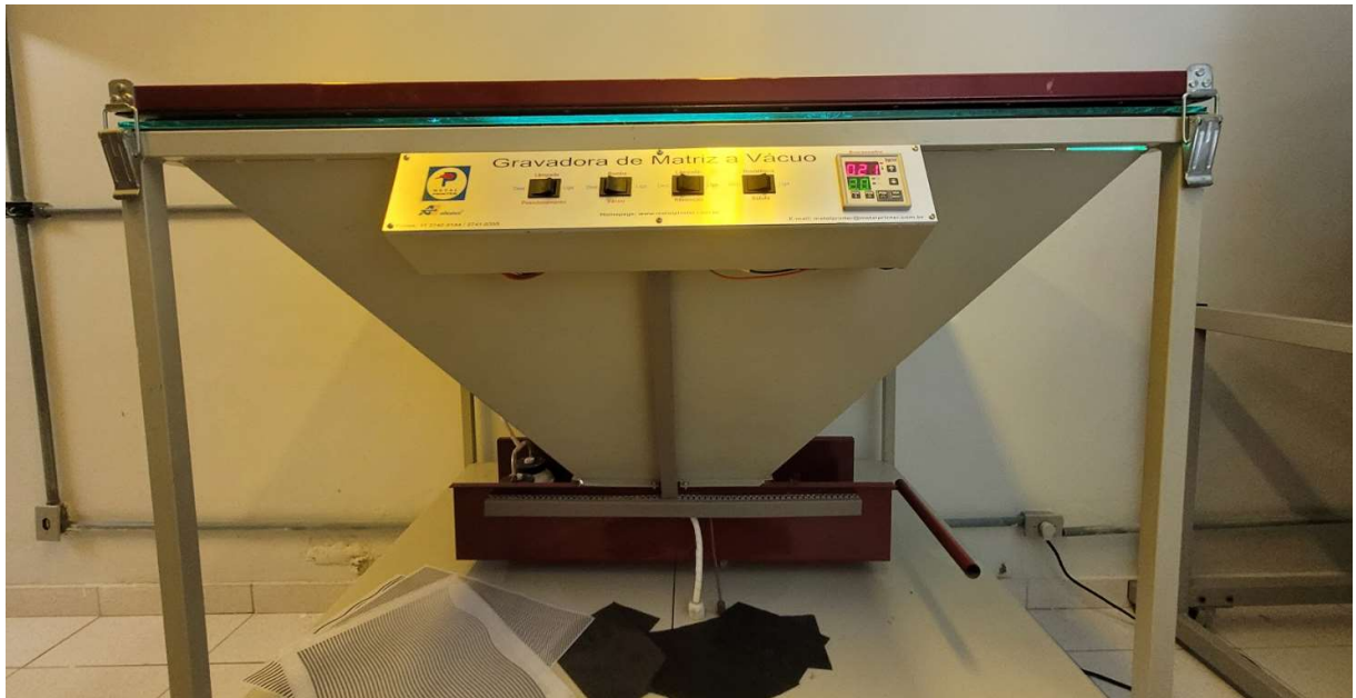
Figura 14: Mesa de revelação do laboratório de serigrafia da UnB (Foto acervo da pesquisadora)
