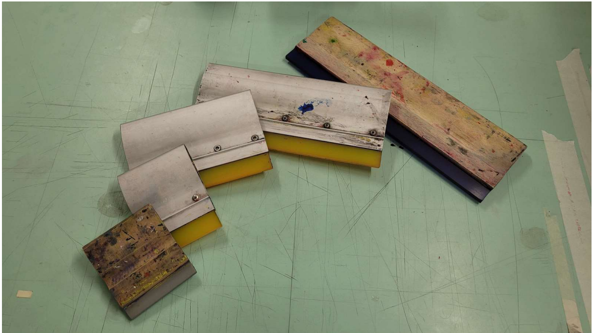
Figura 10: Rodos disponibilizados no laboratório de serigrafia da UnB. (Foto acervo da pesquisadora)
