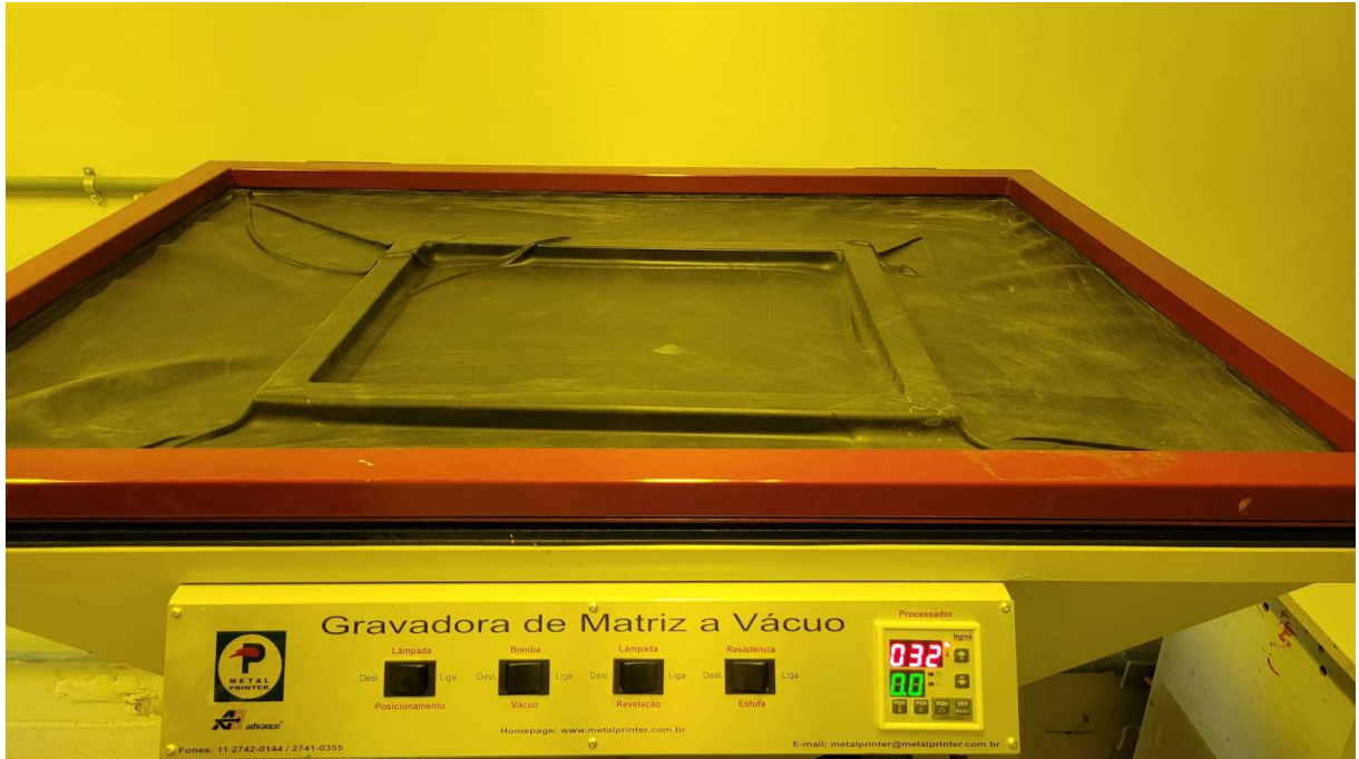
Figura 23: Tela prensada a vácuo na mesa de revelação (Foto acervo da pesquisadora)
