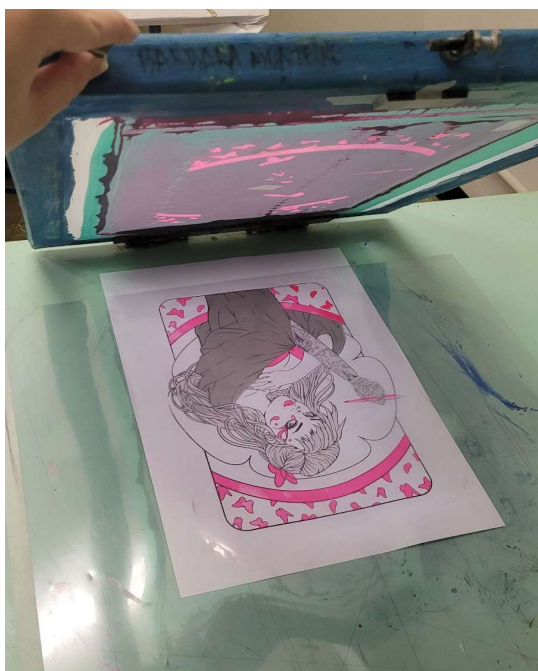
Figura 87: Posicionamento de camadas com auxílio de folha de acetato (Foto acervo da pesquisadora)
