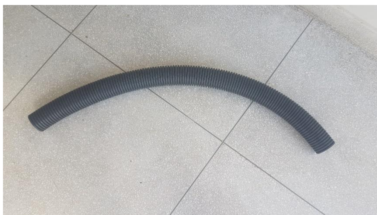
Registro fotográfico 1 - Conduíte corrugado. Fonte: Autor.
