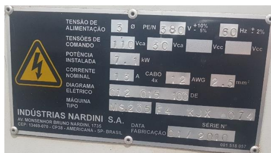
Registro fotográfico 3 – Especificações do torno CNC. Fonte: Autor.
