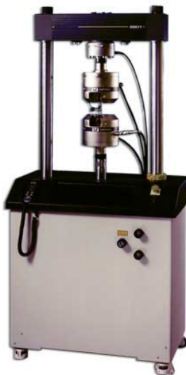
Figura 12 – Máquina de tração Instron . Fonte: Pereira (2019).
