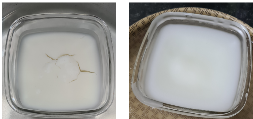
Figura 27 – Amostra 1 com trinca devido ao resfriamento e Amostra 2
