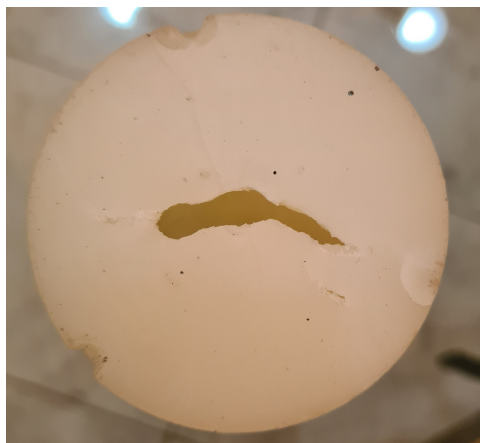
Figura 29 – Grão 2 com deformidade interna.
