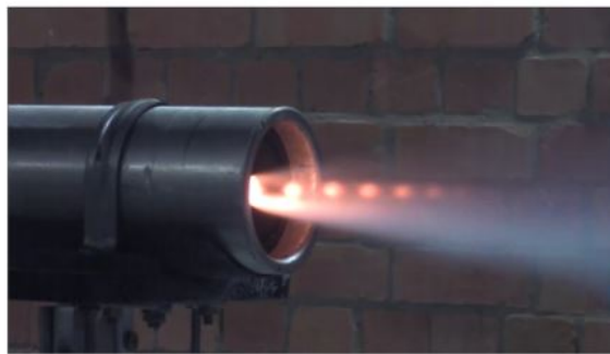
Figura 11 – Exaustão de parafina vaporizada durante um ensaio. (AZEVEDO, 2018)
