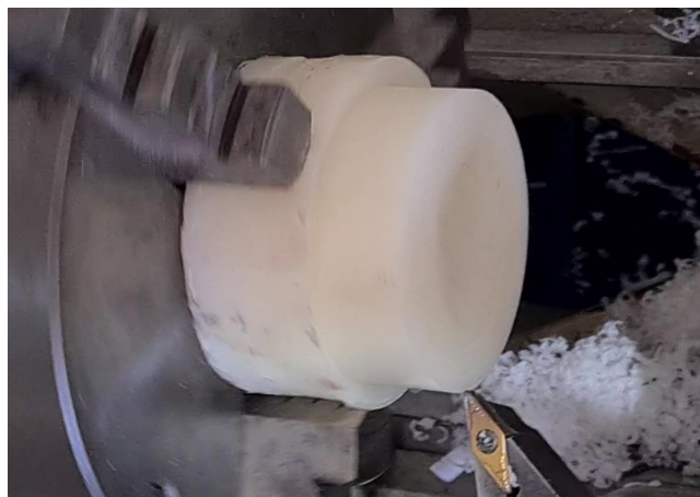
Figura 26 – Grão 4 sendo usinado
