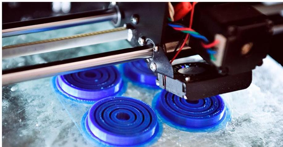
**Figura 4.** Prototipagem rápida - Impressão 3D. Disponível em
