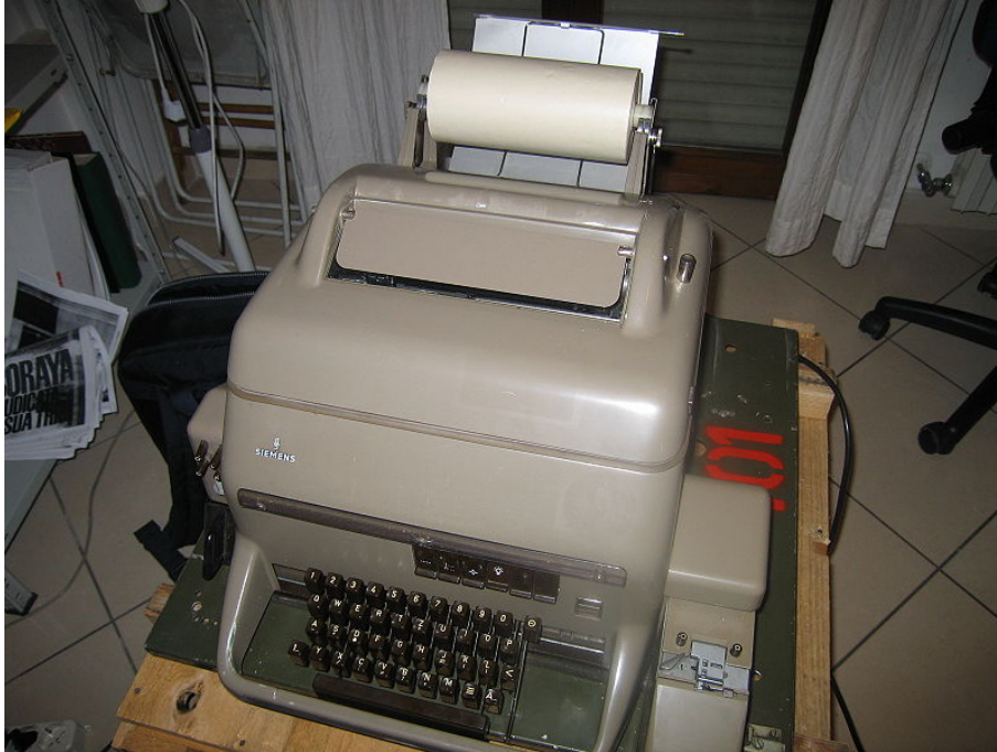
Figura 2 – Teletipo “Fernschreiber 100” fabricado pela Siemens na década de 1960
