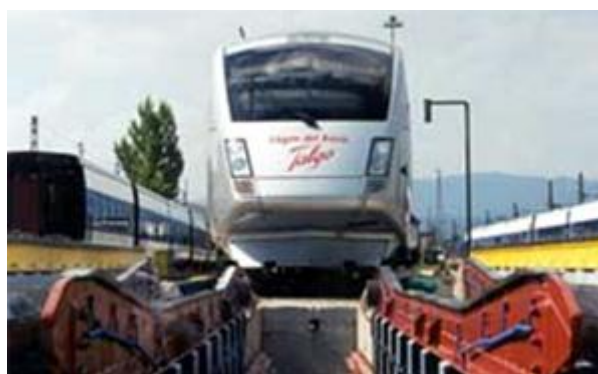
Figura 3.13 - Trem passando por trilho de transferência (Santos, 2011)
