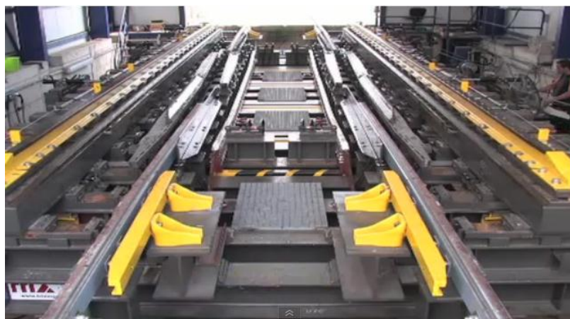
Figura 3.7 Trilho hidráulico de transferência (CAF, 2011)
