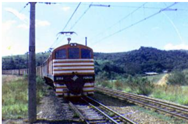
Figura 3.6-Via permanente de duas bitolas (Santos, 2011)
